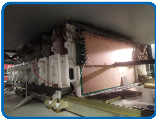
Рис. 9. Слева: Трековые детекторы на основе газовых электронных умножителей (GEM), смонтированные в спектрометрическом магните с помощью точной системы позиционирования. Монтаж произведен главным инженером установки BM@N Семеном Пиядиным и его командой. Вакуумный ионопровод из углепластика проходит детекторы GEM через отверстия для пучка и повторяет траекторию ионов в магнитном поле.
