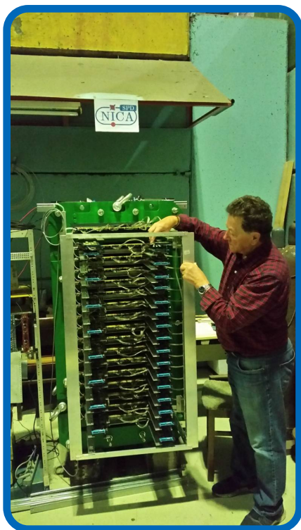
Рис. 6. Тестирование модуля мюонной системы на космических мюонах.
