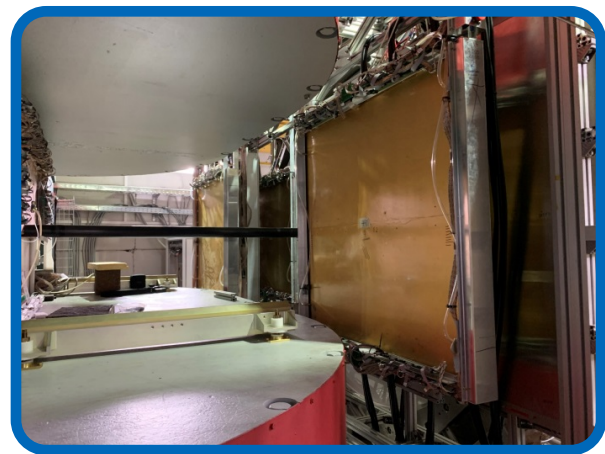
Рис. 9. Слева: Трековые детекторы на основе газовых электронных умножителей (GEM), смонтированные в спектрометрическом магните с помощью точной системы позиционирования. Монтаж произведен главным инженером установки BM@N Семеном Пиядиным и его командой. Вакуумный ионопровод из углепластика проходит детекторы GEM через отверстия для пучка и повторяет траекторию ионов в магнитном поле.
