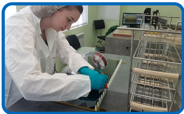
Рис. 4. Слева: Лаборант Анастасия Тимофеева в чистой комнате собирает МРПК для TOF MPD. Справа: Инженер Иван Маликов при сборке модуля TOF MPD устанавливает на него электронику. Fig. 4. Left: A technician Anastasia Timofeeva assembles MRPCs for MPD TOF in a clean room. Right: An engineer Ivan Malikov installs electronics on the MPD TOF module when assembling it.
