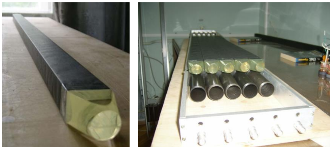
Рис. 27 Время-пролетный годоскоп М-плеча, перед сборкой.
