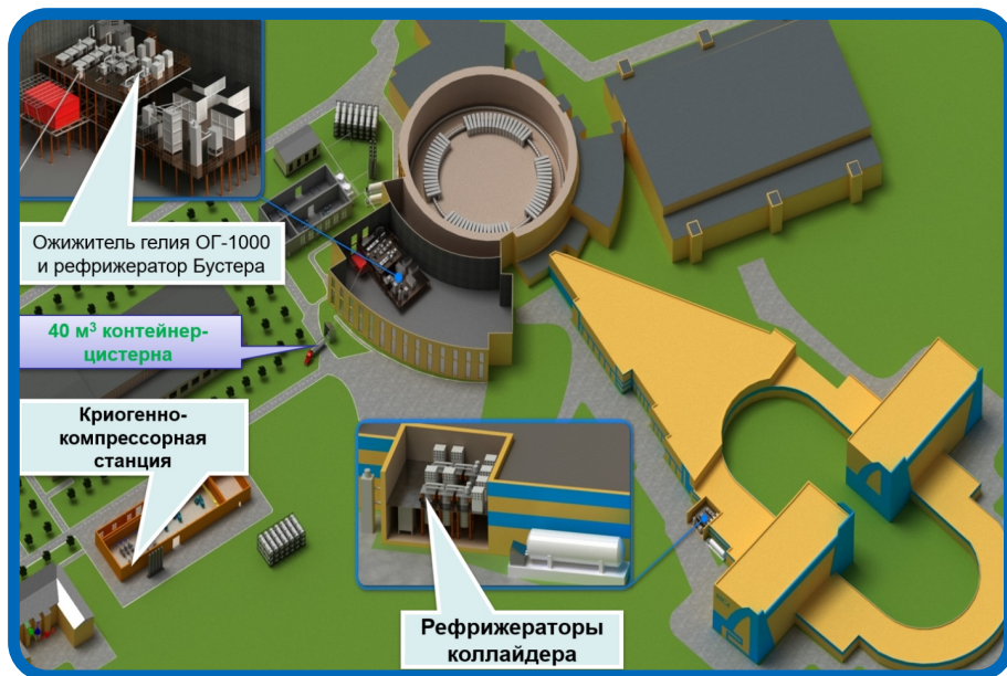
Рис. 11. Размещение установок и оборудования криогенного комплекса. Fig. 11. The location of installations and equipment of the cryogenic complex.
