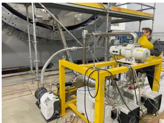
Рис. 4. Испытания и наладка вакуумной системы соленоида.
