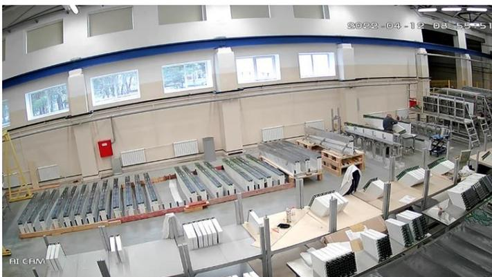
Рис. 9. Собранные кластеры, готовые к установке в корзины полусекторов ECal.
