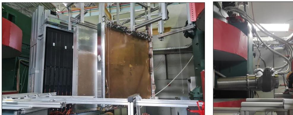
Рис. 18. Компоненты подсистем эксперимента на разных этапах сборки установки: слева – времяпролетный калориметр вместе с TOF-400 и катодно-стриповой камерой, справа – криогенная водородная мишень.
