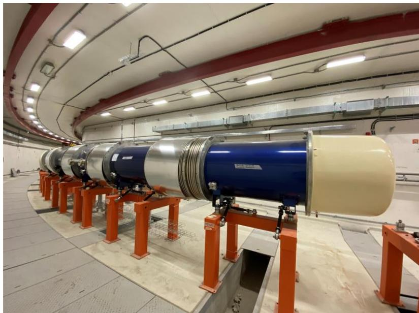
*Рис. 1. Дипольные магниты, установленные в арке туннеля коллайдера.*
