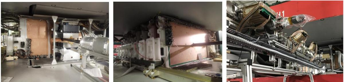
Рис. 14. Установленные компоненты пучковой трубы и центральной трековой системы, состоящей из кремниевых стриповых детекторов и детекторов GEM.
