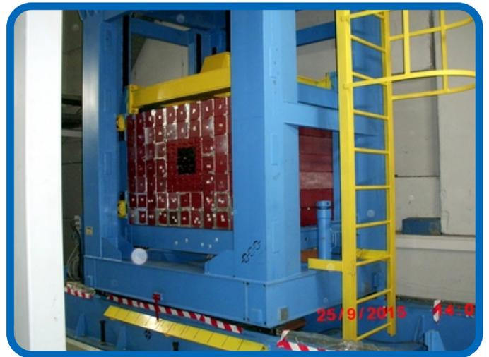
Рис. 9. Калориметр ZDC на установке BM@N.
