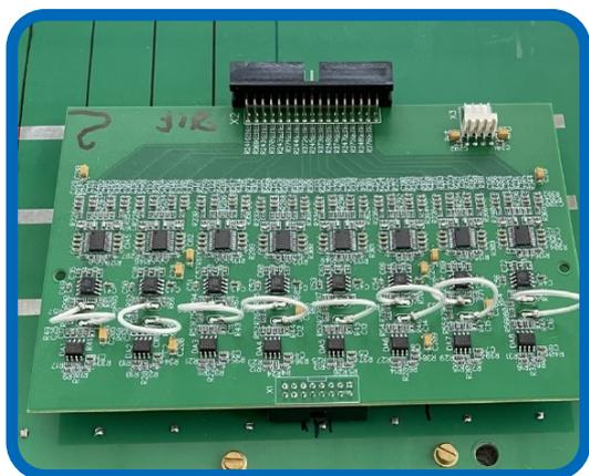
Рис. 13. Плата электроники считывания данных с камер MRPC.
