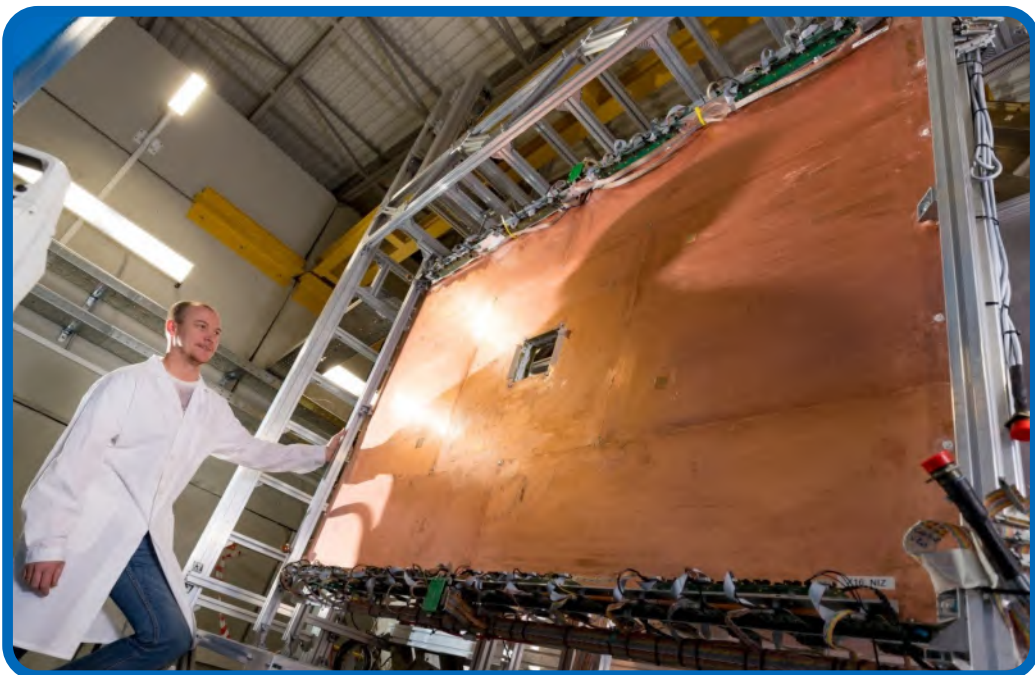
Рис. 6. Монтаж камеры с катодными полосами 2,1 \times 1,5 \text{ м}^2 в установку BM@N. Fig. 6. Installation of the 2.1 \times 1.5 \text{ m}^2 cathode strip chamber into the BM@N facility.
