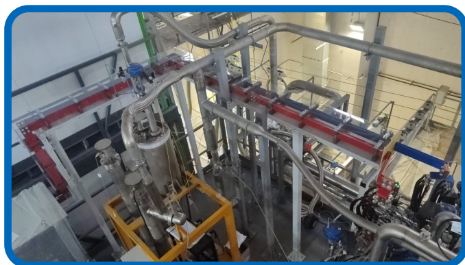
Рис. 6. Вид сверху на шинпровод, соединяющий внешнее сопротивление разрядки (dump resistor), контрольный Дьюар соленоида и источник питания.
